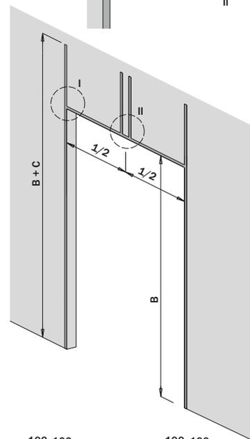
**CZ** Varianta pro montáž 2 pružin (do šířky vrat 4 250mm)
