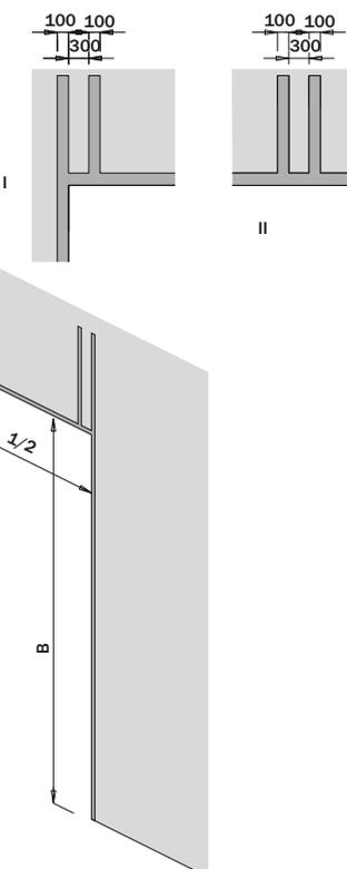
**CZ** Varianta pro montáž 4 pružin (od šířky vrat 4 251mm)
