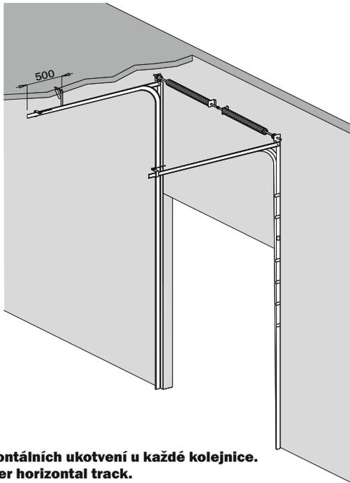
**CZ** Nad výšku vrat 3 510mm je potřeba min. dvou horizontálních ukotvení u každé kolejnice.
