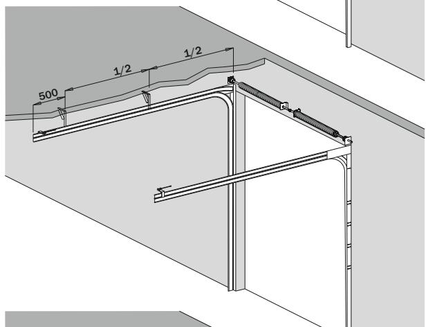
CZ Nad výšku vrat 3 510mm nebo plochy vrat větší jak 20m<sup>2</sup>, je potřeba min. tří horizontálních ukotvení u každé kolejnice.
