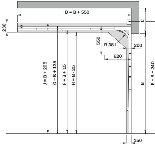
DE A - Lichte Breite (von Torbreite 4 950mm muß man das Gewicht von Versteifungsprofilen zurechnen, Zahl der Versteifungsprofile gleicht der Zahl der Sektionen, Versteifungsprofilgewicht 1,25 kg/m, Sektionsgewicht 13kg/m<sup>2</sup>)
