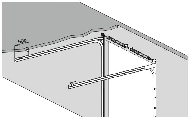
CZ Nad výšku vrat 3 510mm nebo plochy vrat větší jak 15 do 20m<sup>2</sup>, je potřeba min. dvou horizontálních ukotvení u každé kolejnice.
