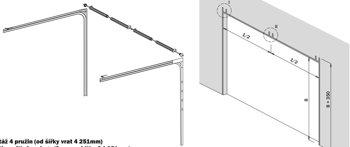
CZ Varianta pro montáž 4 pružin (od šířky vrat 4 251mm)
