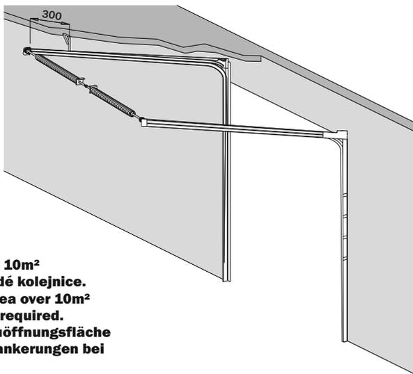
**CZ** Nad výšku vrat 3 000mm nebo plochy vrat větší než 10m<sup>2</sup> je potřeba min. dvou horizontálních ukotvení u každé kolejnice.
