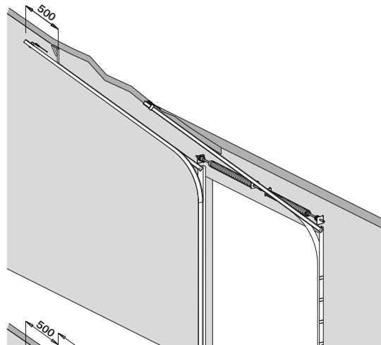
CZ Do výšky vrat 3 500mm nebo plochy vrat větší jak  $15\text{ m}^2$ , je potřeba min. dvou horizontálních ukotvení u každé kolejnice.
