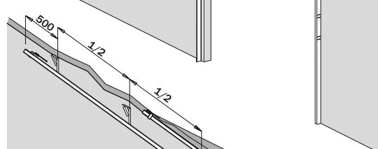
CZ Nad výšku vrat 3 500mm nebo plochy vrat větší jak  $20\text{ m}^2$ , je potřeba min. tří horizontálních ukotvení u každé kolejnice.
