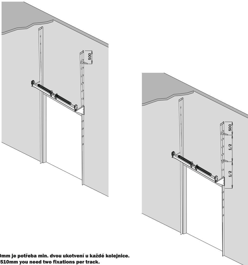
CZ Od výšky vrat 3 510mm je potřeba min. dvou ukotvení u každé kolejnice.
